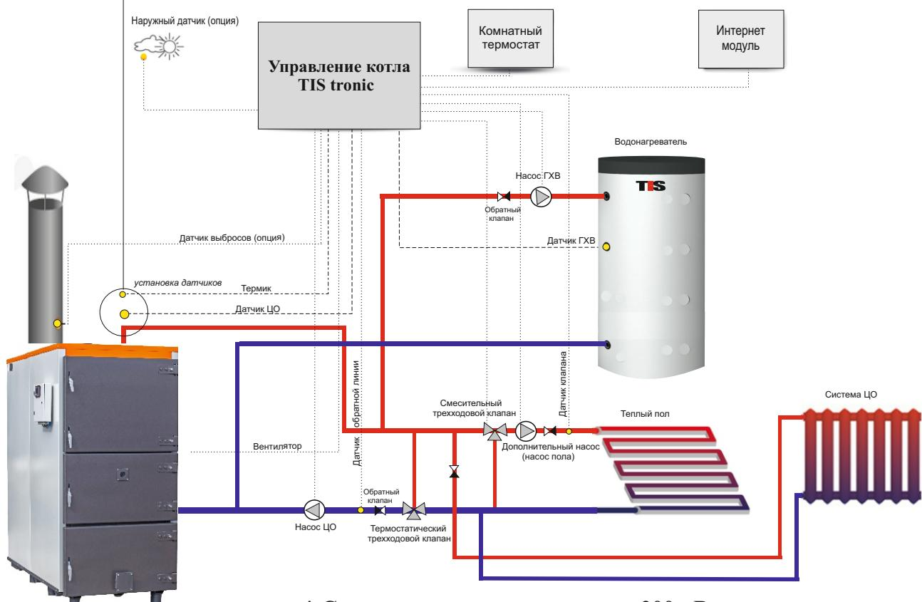
**\* Схема подключения котлов от 200 кВт
