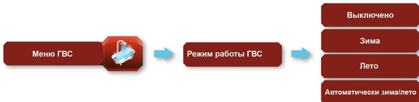
Установка насоса ГВС в зимний, летний или автоматический режим меняет главный экран с неактивного (серый фон) на активный режим. С этого момента насос ГВС работает в одном из выбранных нами режимов. Значение настройки температуры ГВС можно изменить непосредственно на главном экране ГВС с помощью кнопок .
