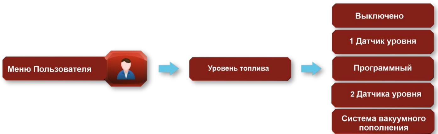
Когда функция «Уровень топлива» активна, появится дополнительный главный экран, показывающий процент заполнения бункера. Дополнительно в главном меню регулятора появится раздел **«Топливо»**, содержащий настройки. В этом же меню есть функция, отвечающая за установку уровня топлива на 100%.
