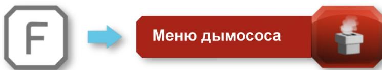
**Выбор типа дымососа** – Параметр позволяет выбрать тип вытяжного вентилятора. Выбор подходящего вентилятора в соответствии с физически установленным в котле вентилятором обеспечивает точное управление скоростью его вращения.
