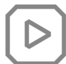
**START/Работа** эта кнопка используется для перевода регулятора в состояние работы. В ручном режиме используется для включения и выключения подключенного механизма. В меню регулятора кнопка СТАРТ/РАБОТА (на экране ДА) используется для входа и редактирования выбранного параметра, а после внесения изменений для их подтверждения.
