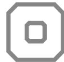
**STOP** - эта кнопка служит для остановки работы регулятора( в режиме главных экранов температур) и выключения работы подключенных устройств в ручном режиме. В меню регулятора кнопка СТОП на экране НЕТ) используется для отмены выбранного параметра без сохранения изменений. Следующее ее нажатие приведет к возврату в меню на один уровень.
