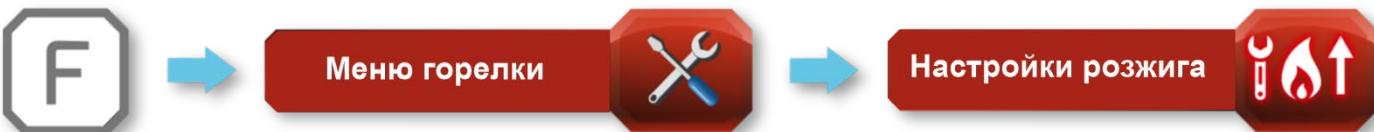
**Время подачи топлива при розжиге** - Параметр определяет, на какое время будет запущена подача топлива для розжига (в зависимости от мощности горелки, может быть, от 6 до 10 сек.).
