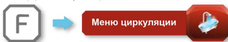
**Работа циркуляционного насоса** – это время, указанное в секундах, которое определяет, на какой период запускается циркуляционный насос (доступный диапазон: 10 ÷ 250 секунд, заводская настройка: 30 секунд).
