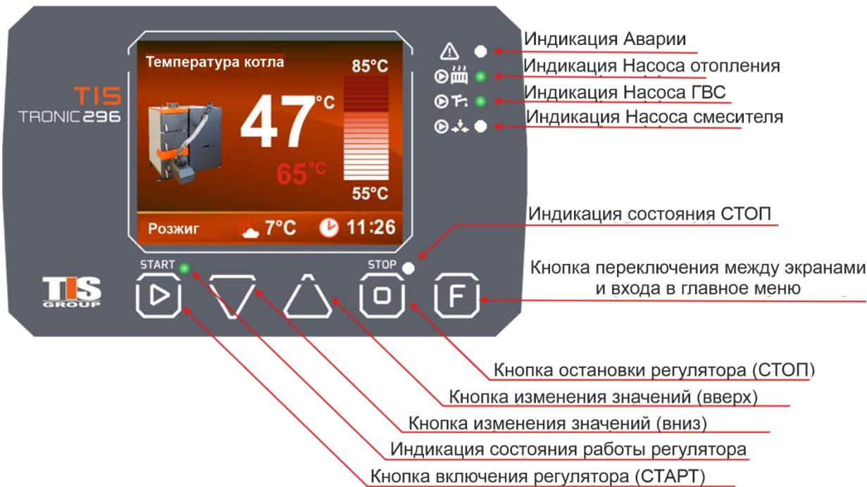
**АВАРИЯ** - указывает на неисправность, например, перегрев воды в котле, повреждение датчика температуры и т. д
