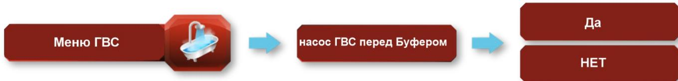
Возможные значения этой функции: «Да» или «Нет». Выбор определяет, откуда будет браться вода для нагрева бойлера ГВС, «ДА» - из источника тепла непосредственно, «НЕТ» - из буферной ёмкости.
