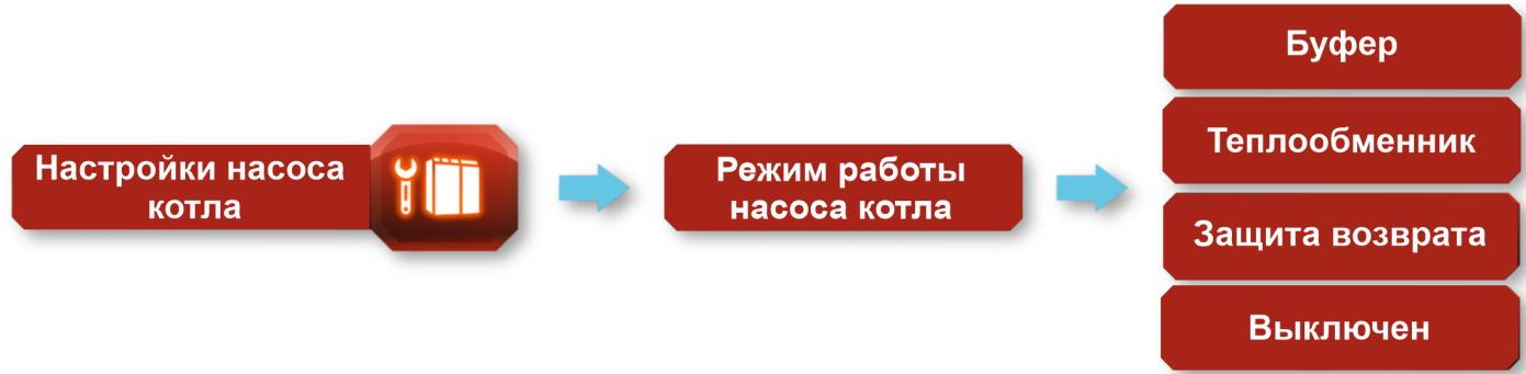
**Буфер** - Режим работы насоса котла, установленный на «Буфер», позволяет взаимодействовать с накопительным баком, который установлен между котлом и системой отопления. При выборе режима «Буфер» активируется дополнительное меню в контроллере и активируется дополнительный экран, содержащий заданную температуру и показания температуры на буфере нижней и верхней.
