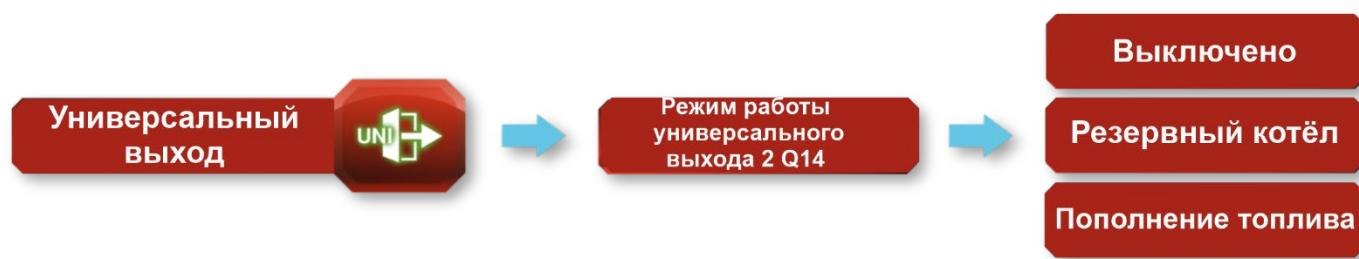
**Циркуляционный насос** – Регулятор оснащен выходом, обслуживающим насос, который отвечает за циркуляцию горячей воды между бойлером и конечными потребителями в системе, например, душем, краном и т. д. Выбор режима универсального выхода в качестве циркуляционного насоса приведёт к появлению меню циркуляции в контроллере, которое содержит функции:
