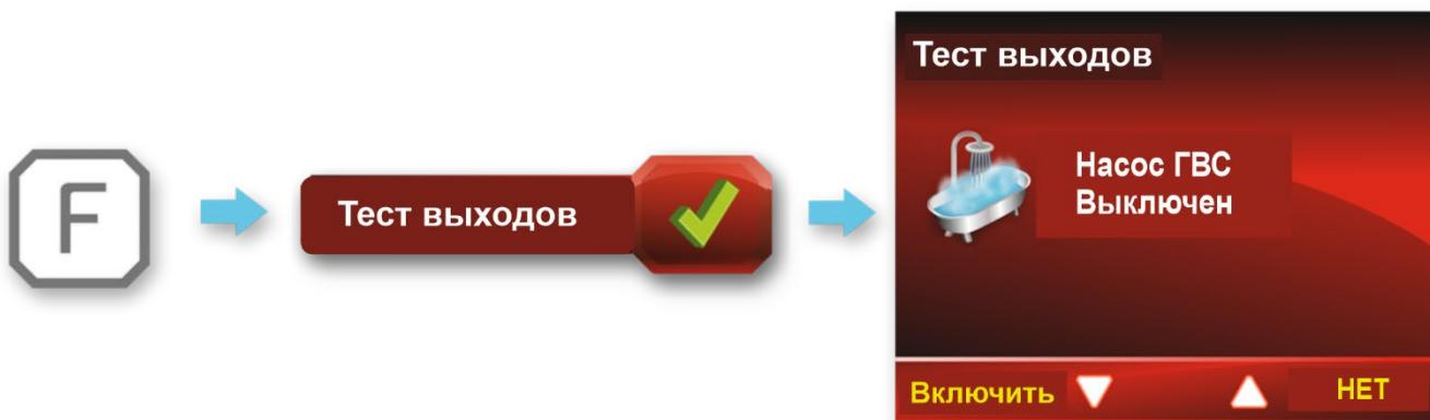
После входа в тестовый режим кнопки отвечают за переключение между доступными устройствами.
