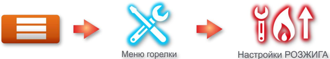
**Время подачи топлива при розжиге** - Параметр определяет, на какое время будет запущена подача топлива для розжига (доступный диапазон: 20 - 250 секунд, заводская настройка: 20 секунд).
