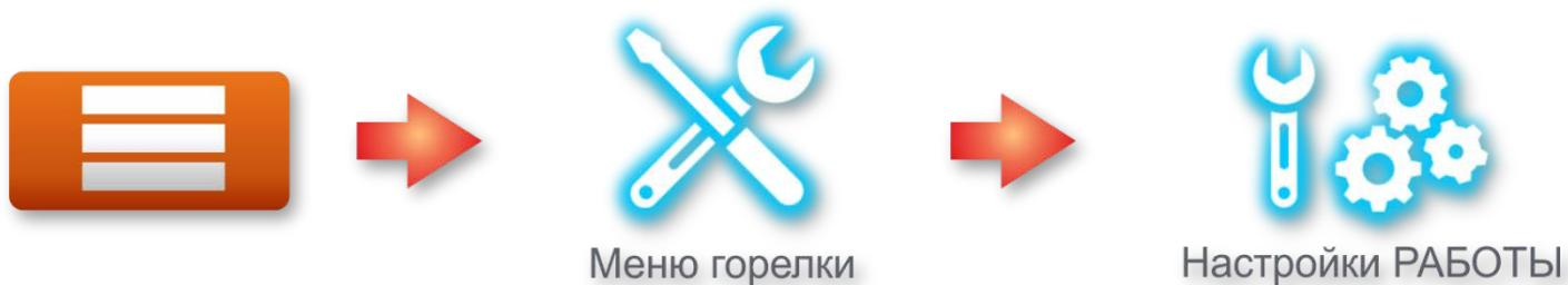
**Время цикла работы подачи** – Функция состоит из времени подачи топлива и времени перерыва между подачами. Пропорциональность времени работы подачи и паузы рассчитывается автоматически на основе текущей потребности в мощности. (доступный диапазон: 1-120 секунд, заводская настройка: 50 секунд).
