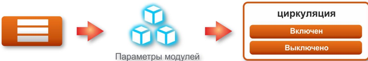
**Работа циркуляционного насоса**- это время, указанное в секундах, которое определяет, на какой период запускается циркуляционный насос (*доступный диапазон: 10-250 секунд, заводская настройка: 30 секунд*)
