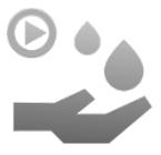
**насос Г.В.С**- сигнализирует о работе насоса горячего водоснабжения.
